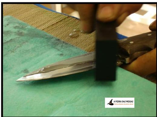
Podemos ver como usando el canto de la piedra, al tener menos zona de contacto el afilado es más rápido. La tabla de madera nos permite sujetar el cuchillo librando la mano. Observemos que la hoja de la piedra está y se mueve a nivel, mientras que el ángulo lo damos con la inclinación del cuchillo.
