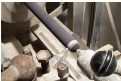
Mi invento y aportación al mundo del afilado consiste en introducir en el interior de la piedra un alma de acero inoxidable, que da a esta una resistencia muy grande por tanto me permite realizar formatos largos y finos, que la misma piedra no sería capaz de soportar si no llevara alma de acero. El acero del interior hace que la herramienta, Chaira siendo de piedra natural sea, fiable, resistente, duradera y lo más importante, eficaz.
